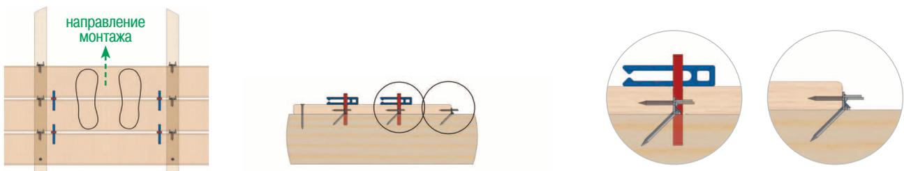
**NB!** Для удобства монтажа рекомендуем использовать биты длиной более 50 мм. Использование регулятора момента вращения на шуруповерте **обязательно!**
